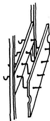
Afb. 78. hakenborden (1 en 2), draaiplanken (3 en 4) en hakenbord met draaiplank (5)
